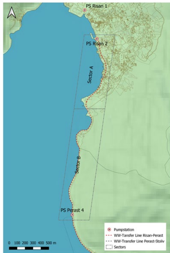
Slika 3.1. Trasa kanalizacione tranzitne linije Risan-Perast
